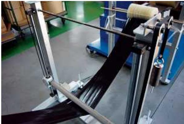
ダンサーによるテンション・張りの調整で、柔らかい素材から硬い素材まで幅広く加工が可能です。
